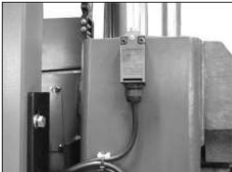
Верхний концевой выключатель высоты пилы.
