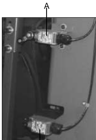
Верхний концевой выключатель высоты пилы.
